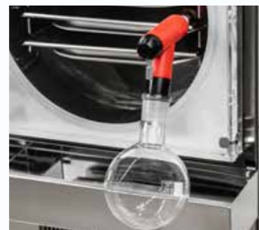
Freeze drying via round flask Gefriertrocknung in Rundkolben
